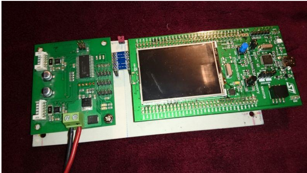
Osadenie vývojového kitu STM32F429Zi – Discovery a motorového driveru MD25 na plošný spoj.
