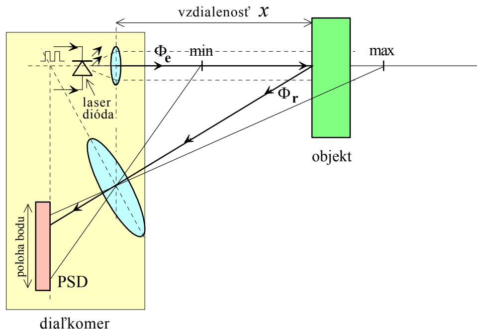
LED dióda (laserová dióda) vytvorí na meranom objekte svetelný bod, ktorý sa optikou premetia na PSD prvok. Poloha bodu na PSD mení jeho výstupné prúdy. Vlnová dĺžka (farba) je na hranici červená - infračervená. Optika takmer neprepúšťa viditeľné svetlo. Integrované obvody obsahujú riadenie LED a vyhodnotenie merania. Výstup je napätie, spojite sa meniacie so vzdialenosťou.
