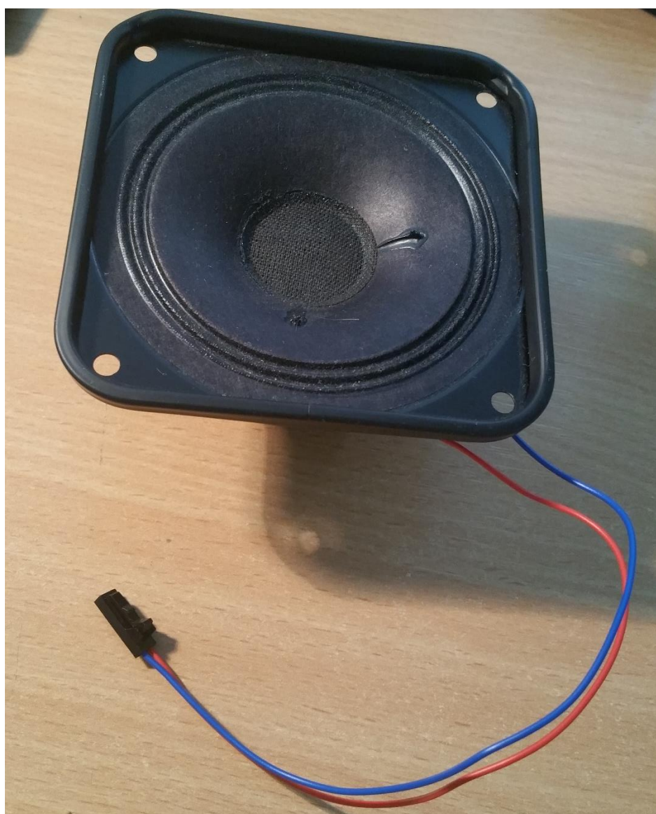
Obrázok 5 : 4 \Omega 3W reproduktor Tesla
