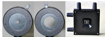
Zmena hĺbky ostrosti, ale aj spektrofotometer – zúženie spektra za hranolom
