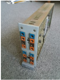
Modul TZK-10 z analogového počítača MEDA: dvojica elektronických komparátorov/spínačov s indikáciou zopnutia a prúdovým výstupom.
