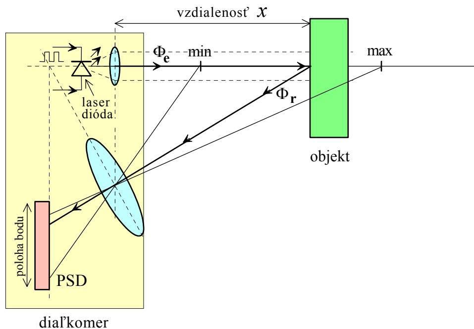
LED dióda (laserová dióda) vytvorí na meranom objekte svetelný bod, ktorý sa optikou premieta na PSD prvok. Poloha bodu na PSD mení jeho výstupné prúdy. Vlnová dĺžka (farba) je na hranici červená - infračervená. Optika takmer neprepúšťa viditeľné svetlo. Integrované obvody obsahujú riadenie LED a vyhodnotenie merania. Výstup je napätie, spojite sa meniace so vzdialenosťou.
